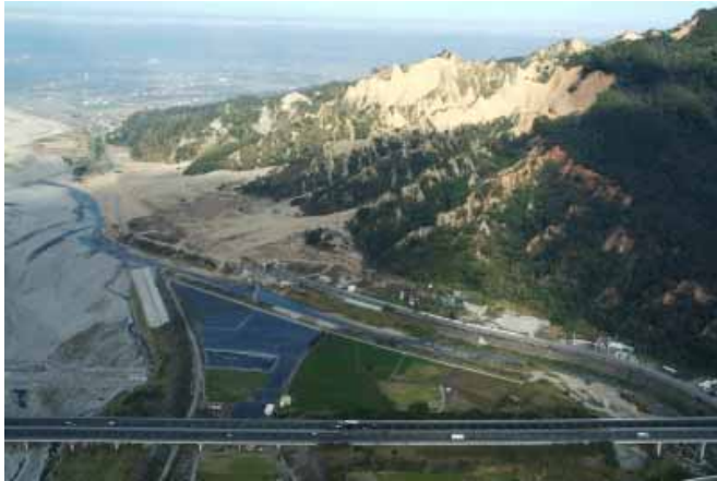
圖 10. 火炎山山麓砂石場林立，過度開採已衍生山崩、石頭河潛移與碎石坡滑動。
