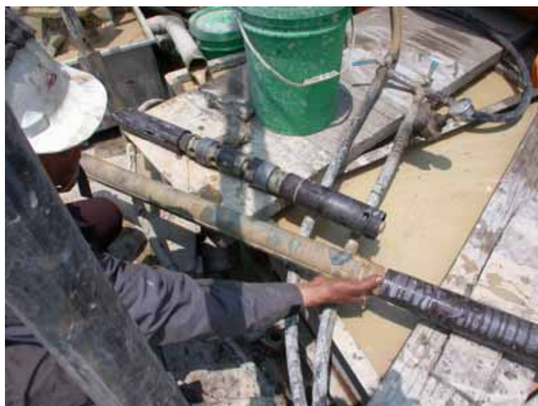
圖 5. 桃園縣觀音鄉大堀溪出海口南側潮間帶深鑽孔作業，剛從岩心管取出的古石門沖積扇礫岩岩心，圖中 1 公尺深度的岩心鑽探需 4 小時。
