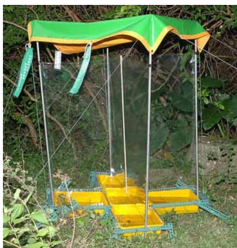
圖 3. 本計畫自製的常置型飛行攔截網(flight interception trap)用來輔助調查螢火蟲的種類與物候。
