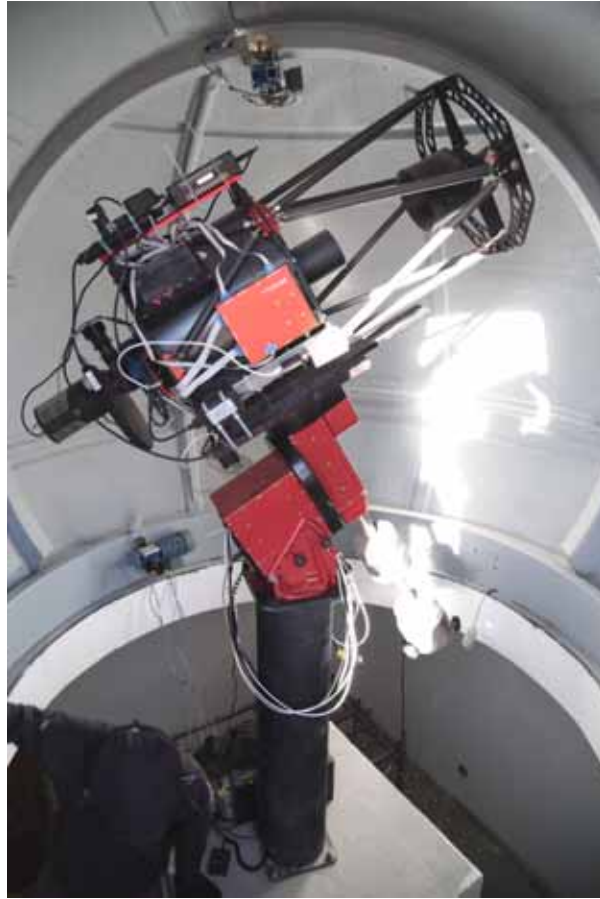
圖 5. 本館 40 公分口徑反射式望遠鏡
