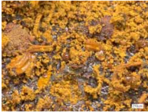
圖 2. 鐵器表面覆蓋著黃褐色鏽蝕物，全焦段數位顯微鏡拍攝。(泰納沃克提供)
