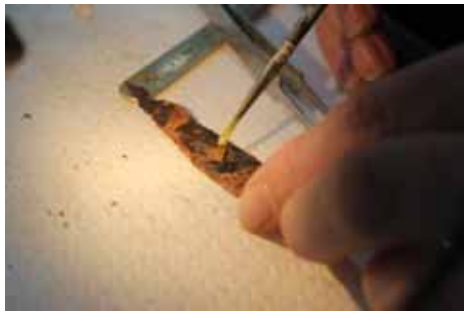
圖 3. 黏合鐵器標本剝落碎片 (泰納沃克提供)
