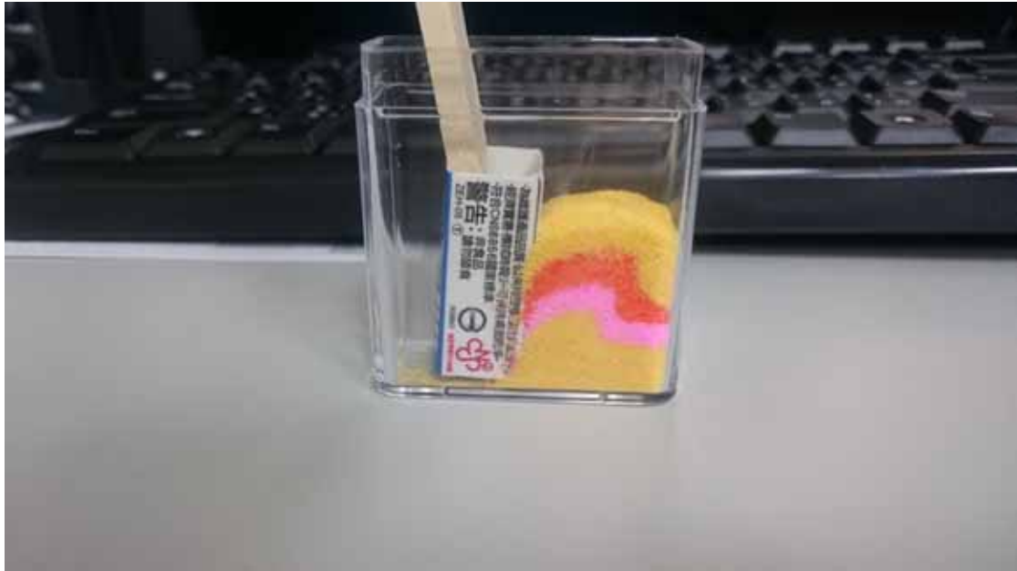
圖 2. 利用簡易文具進行砂箱實驗，經過側向擠壓可形成逆斷層。
