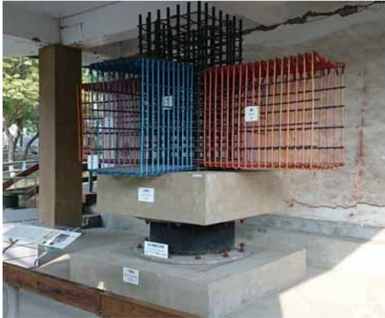
圖 5. 國內自製「積層鉛心橡膠支承(LRB)」隔震器實品
