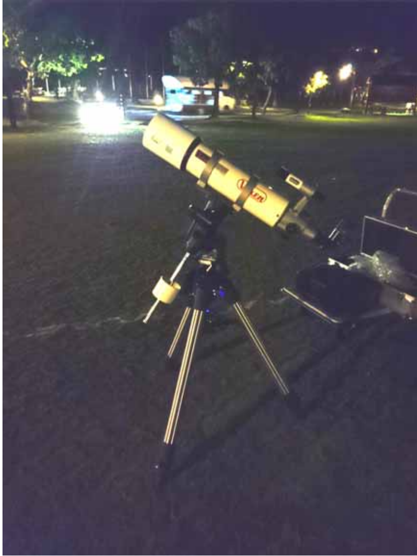
圖 4. 常見的可攜式小型望遠鏡與赤道儀，易於觀察暗天體。
