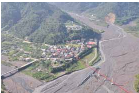
圖 1. 寒溪部落。大同鄉寒溪部落、寒溪橋以及寒溪吊橋。乾季車輛行駛河床便道，大水時村落與外地聯絡有賴寒溪吊橋。
