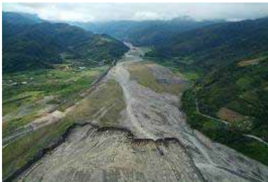
圖 9. 蘭陽溪牛鬥橋下游河川地，在芭瑪颱風前為大規模砂石採掘場，依目前情況看勢必影響採掘區左前方牛鬥堤防的安全。
